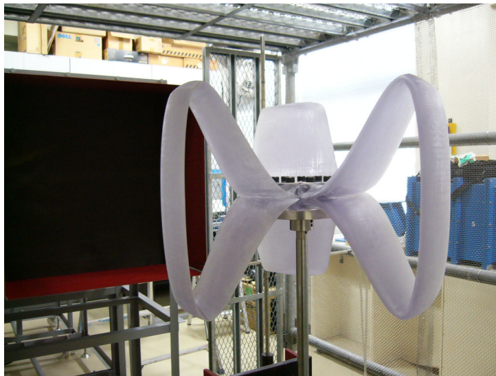
図1 小型風洞の吹出口(左の黒い部分)とバタフライ風車 (吹出口面積に比べて風車の大きさが大きく見えるが、 実際の寸法は、風車の受風面積は吹出口断面積の約 28.4%)
